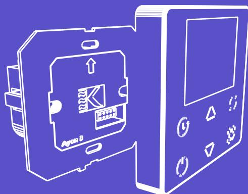
پنل رویی را بر روی قطعه‌ی پاور قرار دهید و فشار دهید تا قلاب‌های نگه‌دارنده در جای خود قرار گیرند. طراحی کانکتور دستگاه به گونه‌ای است که تنها از یک جهت قابل نصب می‌باشد.
